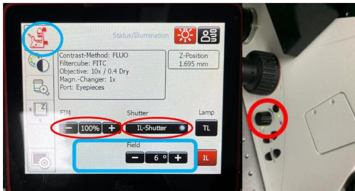
物镜的切换可以在显微镜触摸屏也可以在软件进行。
